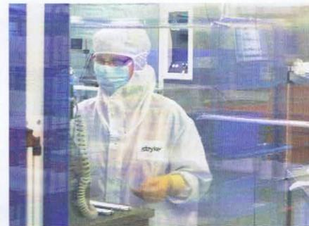
Verpacken unter Reinraumbedingungen. Der erste Schritt zum sterilen Produkt
